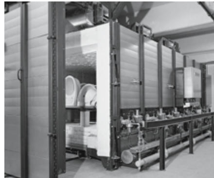
Keramikofen mit Tem- peraturregelung über Taktsteuerung
