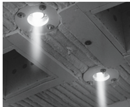
Deckenbefeuerung mit Brenner BIC
