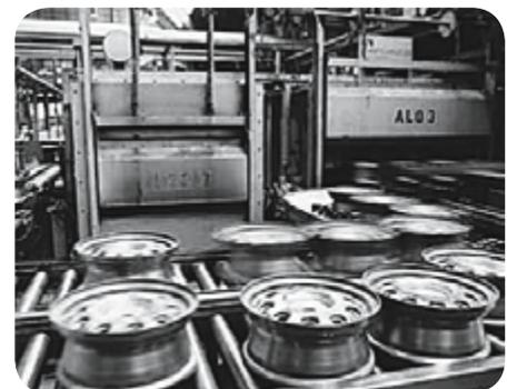
Aluminium-Aushärteofen mit Gleichdruckreglern zur Luftmangelsicherung
