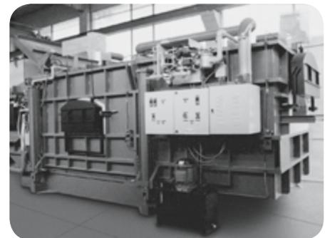
Gleichdruckregler am Schmelzofen zur Sicherstellung einer stöchiometrischen Verbrennung über den gesamten Leistungsbereich
